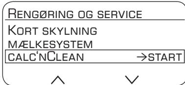
Under de enkelte calc'nClean trin blinker tasten **8 start**. Tallene øverst til højre angiver, hvor langt programmet er nået.
