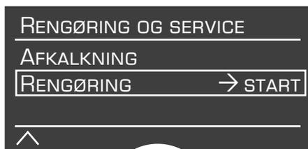
**Start**-knappen **8** blinker i forbindelse med de forskellige rengøringsprocesser. Tallene øverst til højre angiver, hvor langt programmet er nået.
