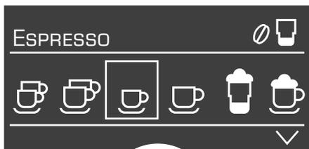
**Info:** Denne automatiske espressomaskinen er fabrikkinnstilt med standardinnstillinger for optimal drift. Maskinen slås automatisk av etter 1 time. (se kapitlet "Menyinnstillinger" under avsnittet om å slå maskinen automatisk på og av, "AUTOMATISK AV OM").
