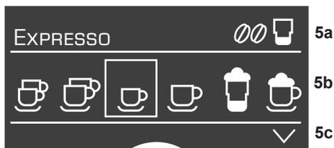
A linha de estado **5a** do display **5** indica o nome da bebida e, a intensidade, por ex.  $\circ\circ$  e a quantidade, por ex.  $\text{☕}$ . A linha de selecção **5b** visualiza os símbolos para a selecção do tipo de bebida. As setas na linha de navegação **5c** indicam quais as opções ainda disponíveis.
