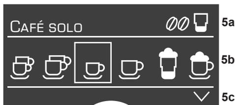
En la barra de estado **5a** del display **5** se visualiza el nombre del tipo de bebida y el ajuste de la intensidad p.ej.  $\circ\circ$  y de la cantidad p.ej.  $\text{☕}$ . En la barra de selección **5b** se representan símbolos para la selección de bebidas.
