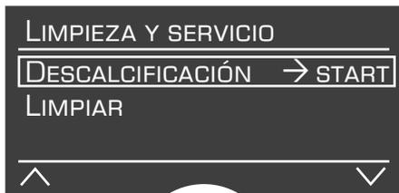
La tecla **8 start** parpadea durante los distintos pasos de descalcificación. Los números que se visualizan en la parte superior derecha indican el avance del proceso.
