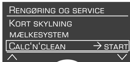
**Start**-knappen **8** blinker i forbindelse med de forskellige Calc'n'Clean trin. Tallene øverst til højre angiver, hvor langt programmet er nået.
