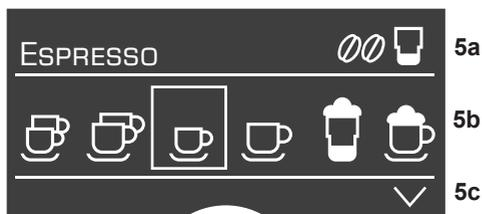
På statuslinje **5a** i displayet vises navnet på drikken samt indstillingen for styrke, f.eks.  $\infty$  og mængde, f.eks.  $\text{☒}$ . På valglinjen **5b** vises symboler for valg af drikke. Pilene i navigationslinjen **5c** viser, hvor menuniveauerne (retning) befinder sig.
