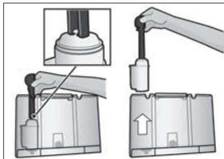
**Tiedoksi:** Kun suodatin **29** huuhdellaan, aktivoituu samalla asetus suodattimen vaihdon näyttöä varten.
