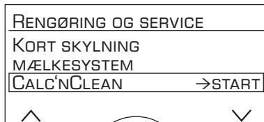
Under de enkelte Calc'nClean trin blinker tasten **8 start**. Tallene øverst til højre angiver, hvor langt programmet er nået.
