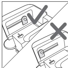
**Obs.:** antes de voltar a posicionar o distribuidor de leite na parte superior da jarra de leite, coloque o perno dentro da parte superior da posição correcta. Se o perno não se encontrar na posição correcta, não pode voltar a posicionar o distribuidor de leite na parte superior da jarra de leite.
