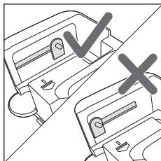
**Nota:** antes de volver a colocar la boquilla de la jarra de leche en la parte superior de la jarra de leche, situar el perno ubicado en el interior de la parte superior en la posición correcta. Si el perno no está en la posición correcta, no será posible volver a colocar la boquilla de la jarra de leche en la parte superior de la jarra de leche.
