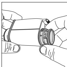
Configurar el filtro de agua “INTENZA+” de acuerdo con las mediciones efectuadas (ver “Medición de la dureza del agua”) y las referencias de la base del filtro:
