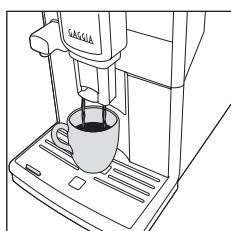
**Obs.:** Para preparar duas chávenas de Espresso ou Espresso lungo, pressione a tecla da bebida desejada duas vezes. A máquina efectua automaticamente dois ciclos de moagem de seguida.
