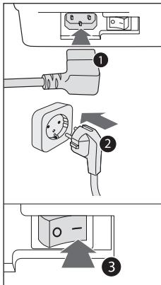
Introduza a ficha na tomada de corrente situada na parte de trás da máquina e a extremidade oposta do cabo de alimentação numa tomada de corrente de parede com a tensão adequada.
