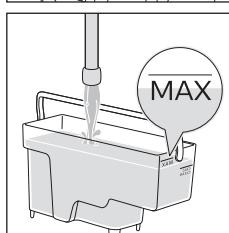
Extraer el depósito de agua, enjuagarlo y llenarlo con agua corriente hasta el nivel MAX. Al volver a colocar el depósito en su compartimento, asegurarse de que queda completamente insertado hasta el fondo.
