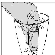
Quitar el filtro blanco presente en el depósito de agua y guardarlo en un lugar seco. Sumergir el filtro de agua “INTENZA+” en posición vertical (con la abertura hacia arriba) en agua fría, apretando suavemente en los lados para que salgan las burbujas de aire.
