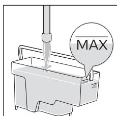
Extraia o reservatório de água, enxágüe-o e volte a enchê-lo com água corrente até ao nível MÁX. Verifique que o reservatório é introduzido completamente até ao fundo no compartimento.
