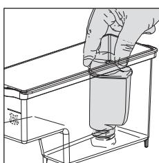
Insertar el filtro de agua “INTENZA+” en el depósito de agua vacío, empujándolo hasta el punto más bajo posible.
