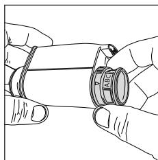
Programe o filtro de água "INTENZA+" de acordo com as medições efectuadas (consulte "medição da dureza da água") e especificadas na base do filtro:
