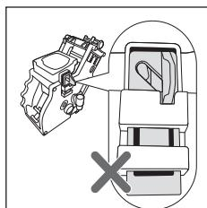
Si el gancho aún está en la posición inferior, significa que no está colocado correctamente.
