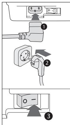
Insertar el enchufe en la toma de corriente situada en parte trasera de la máquina y conectar el extremo opuesto del cable de alimentación a una toma de corriente de pared de tensión adecuada.
